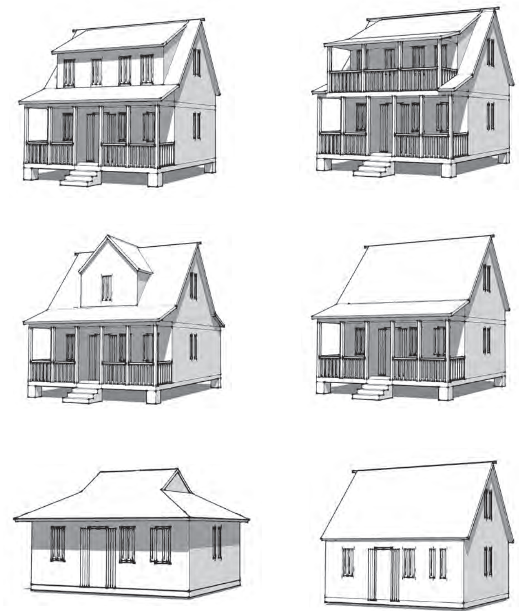
Figura 4. Tipos shed roof , darma , garat , V-top , round top y básica (de izquierda a derecha) Fuente: dibujos de Santiago Moreno, 2020.
